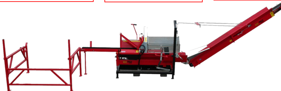
Ilustrační foto sestavy procesoru Vedkombi 370 s připojeným příslušenstvím.
